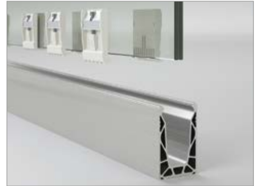
2 Assemblage pince, entraxe des pinces sur le verre 250 mm - 4 pinces/m
