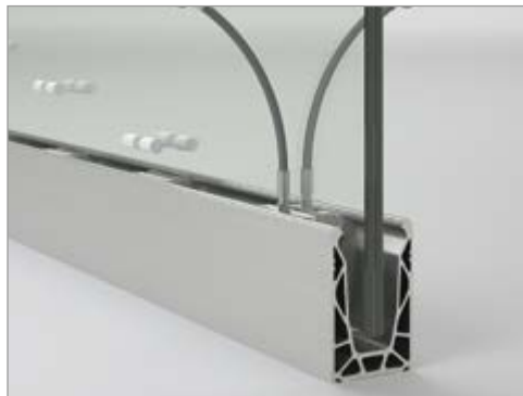
4 Introduction des rouleaux en POM. Les rouleaux garantissent la meilleure distribution de la charge sur l'interface verre/pince/profil, en maximisant la performance du système. Réglage et serrage avec visseuse. Couple de serrage 3 Nm
