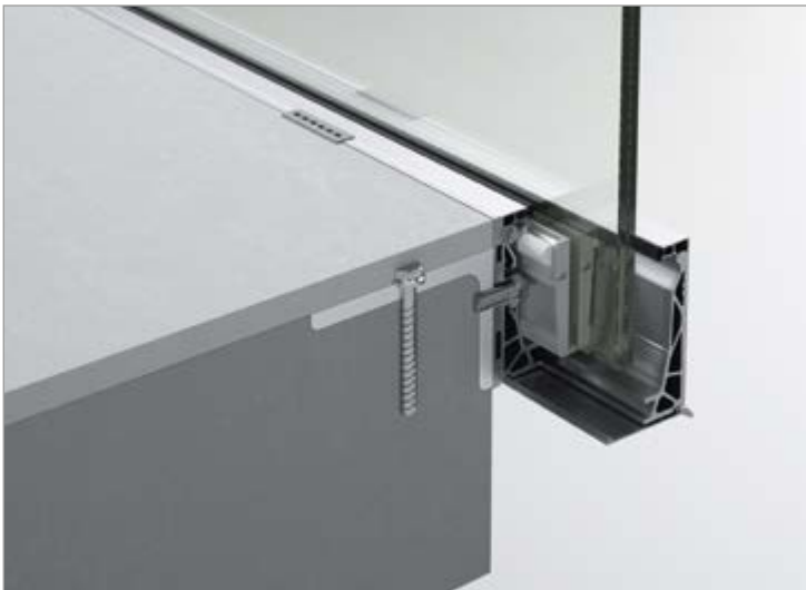
ANCRAGE EN NEZ DE DALLE AVEC RENFORT EN L Évacuation de l'eau de la terrasse
